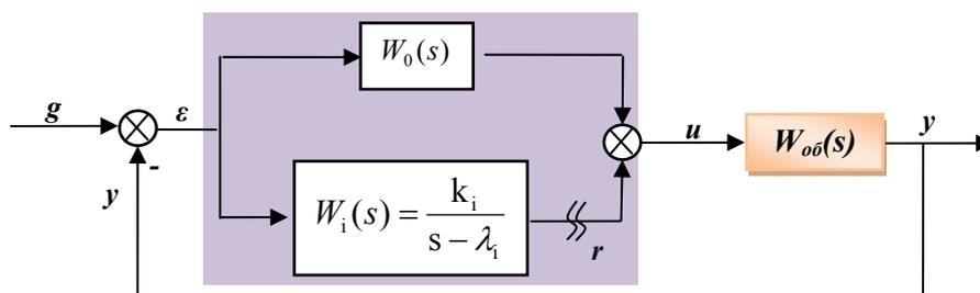
Рис. 2. Структурная схема системы (1), (4), разомкнутой по  $i$ -му слагаемому передаточной функции регулятора.
