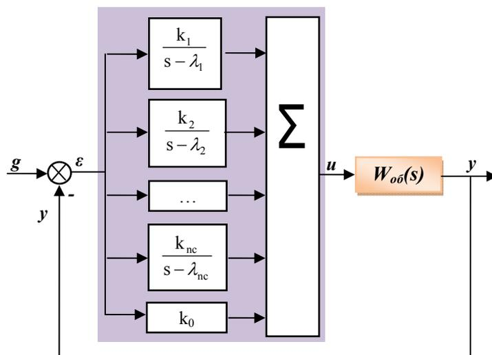
Рис. 1. Структурная схема замкнутой системы (1), (4).
