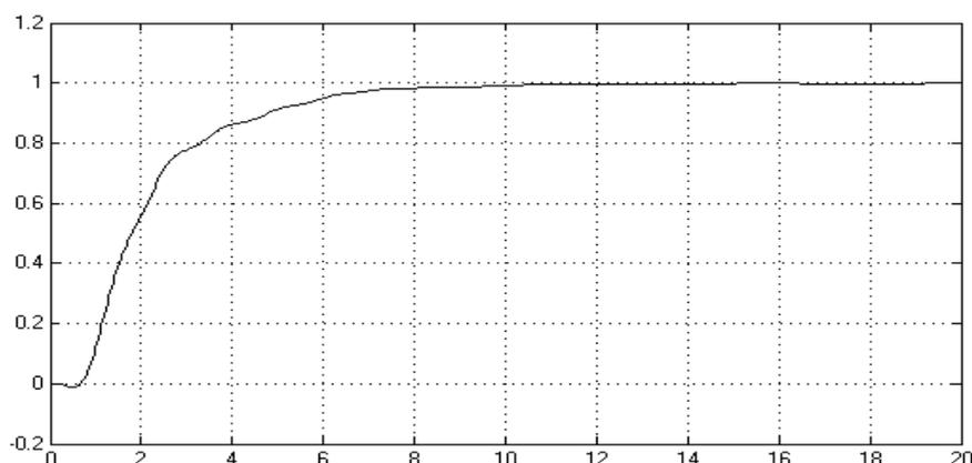
**Рис. 6.** Реакция выхода  $y(t)$  системы с редуцированным регулятором на единичное ступенчатое воздействие.
