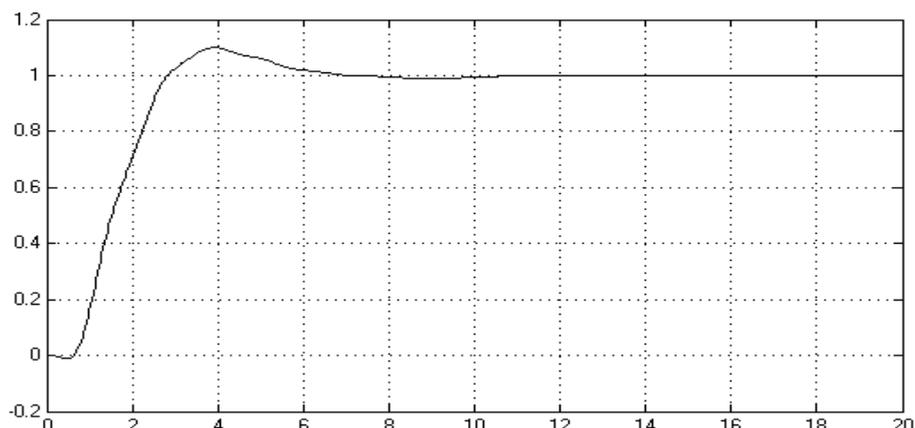
Рис. 4. Реакция выхода  $y(t)$  на единичное ступенчатое воздействие.
