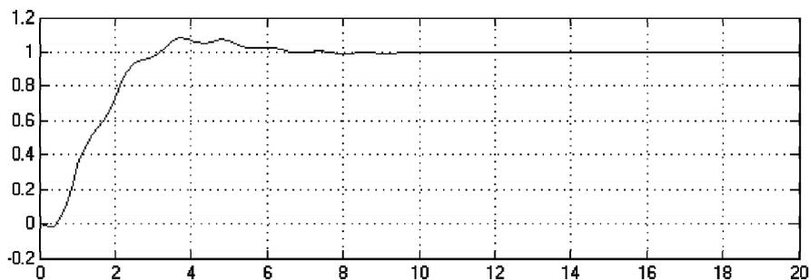
Рис. 5. Реакция выхода  $y(t)$  на единичное ступенчатое воздействие (система с редуцированным регулятором).
